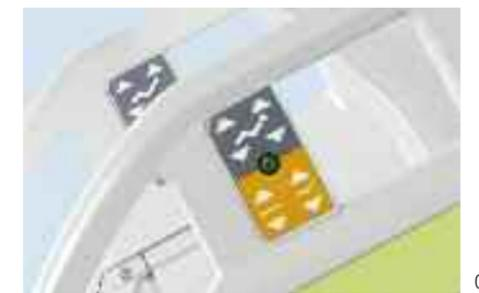
**05 Pédale de commande** (option) La position du lit peut être changée rapidement et en respectant les règles de l'hygiène sans l'aide des mains. Le réglage à une hauteur confortable pour, par exemple l'administration des soins, est facilement obtenu et préserve ainsi le dos du personnel soignant. Il est également possible de condamner la pédale de commande par le Superviseur. L'arceau de protection protège contre les manipulations involontaires.
